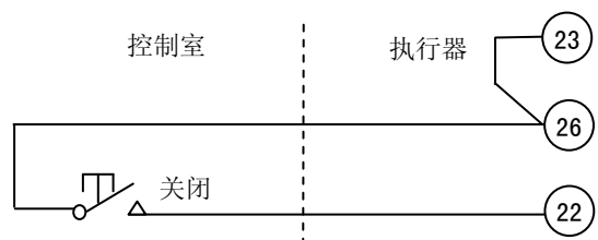
图 4-11 两线控制，有信号关，无信号开
