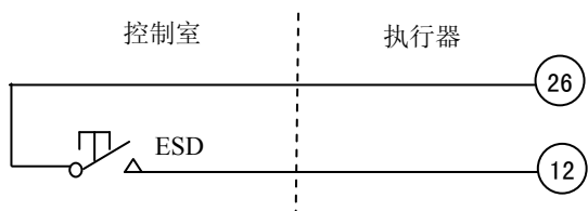
图 4-14 单线 ESD 控制，高电平有效
