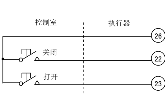
图 4-4 点动式打开/关闭控制，执行器可以停在中途任意位置
